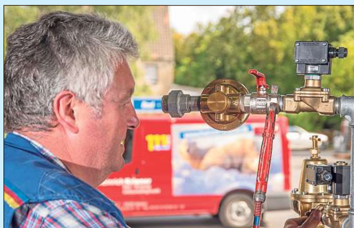
Jürgen Assmann, Obermonteur, bei der Fertigung eines Druckluftverteilers.
